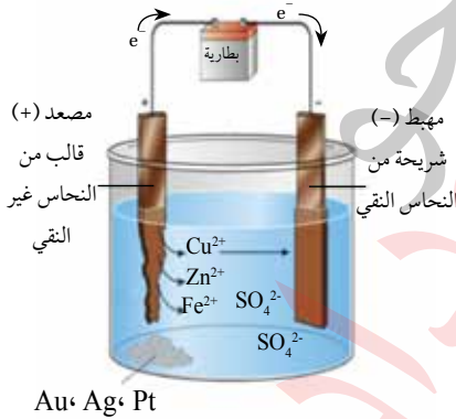
الشكل (20): تنقية النحاس بالتحليل الكهربائي.
